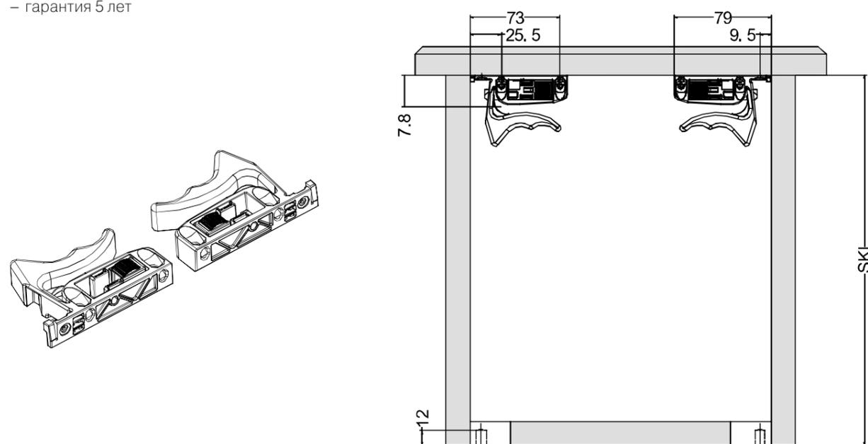
Установочные размеры для ЛДСП толщиной 16 мм
