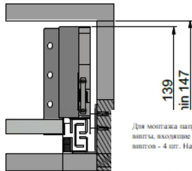
Для монтажа направляющих в корпус используйте винты, входящие в комплект, оптимальное количество винтов - 4 шт. На одну направляющую.
