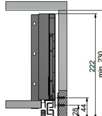
Для монтажа направляющих в корпус используйте винты, входящие в комплект, оптимальное количество винтов - 4 шт. На одну направляющую.
