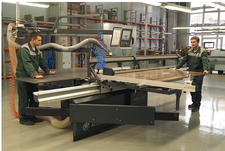
Полуавтоматический форматно-раскroечный круглопильный станок ALTENDORF отличается высоким качеством распила высокоглянцевых плит, отсутствием сколов и повреждений на глянцевой поверхности.
